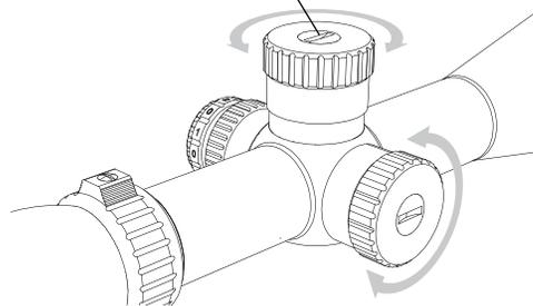
serrez la vis pour verrouiller la tourelle. Il n'existe aucune fonction d'arrêt du point zéro pour la tourelle de direction du vent.
