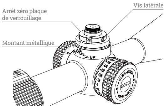
En ajustant le fusil à 100 yards, le tireur peut calculer le nombre de clics d'ajustement qui sont nécessaires pour des distances différentes, ou pour des conditions de vent. Après le tir, le tireur peut rapidement tourner le bouton
