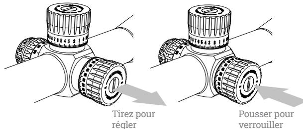
En ajustant le fusil à 100 yards, le tireur peut calculer le nombre de clics d'ajustement qui sont nécessaires pour des distances différentes, ou pour des conditions de vent. Après le tir, le tireur peut rapidement tourner le bouton d'élévation dans la direction des aiguilles d'une montre (direction vers le bas) et revenir à son/sa position zéro une fois que le bouton ne peut pas être tourné plus. N'inversez pas le bouton d'élévation une fois qu'il est arrêté.
