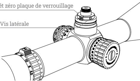
Il y a une fonction de verrouillage pour le bouton de dérive. Cette fonction vous permet de tirer sur le bouton pour tourner et pousser pour le verrouiller en position. Il n'y a pas de fonction d'arrêt zéro pour le bouton de visée.
